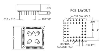
**Description:**PLCC Through Hole PLCC Socket
