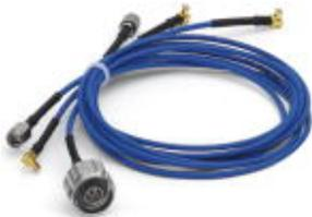
Adapterkabel, Pigtail 50 cm MCX(male) -> N(male), Einfügedämpfung 1,5 dB@2,4 GHz; Impedanz 50 Ω;
